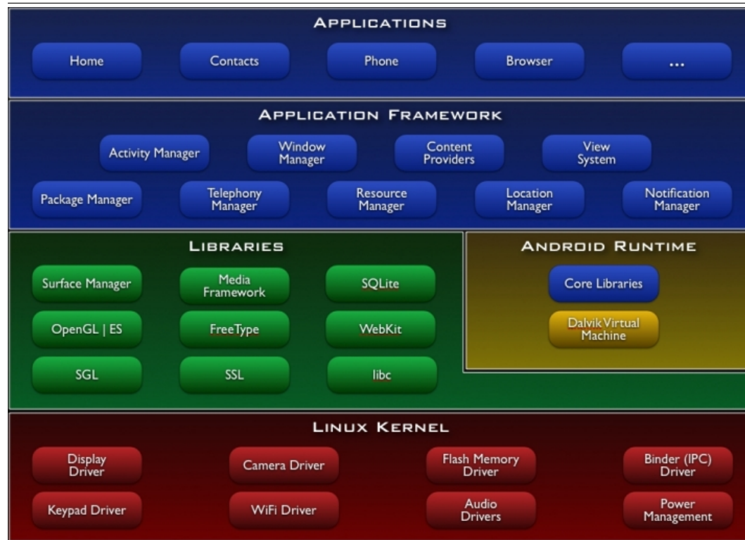
Figura 6.1 Architettura della piattaforma Android
